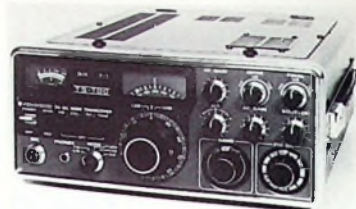
Bild 3 2-m-Transceiver „TS-700“ für AM, FM, SSB- und CW-Betrieb (Kenwood)
