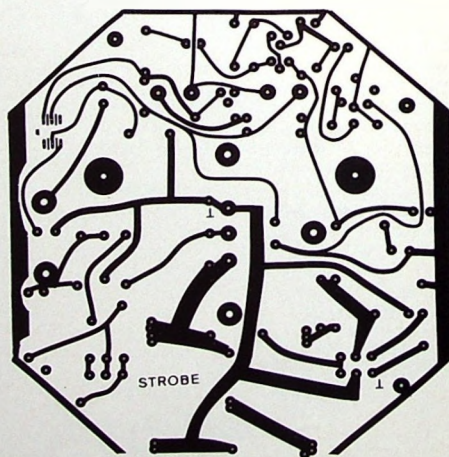
Bild 5. Printplatte für das Lichtblitz-Stroboskop (Maßstab 1:2)
